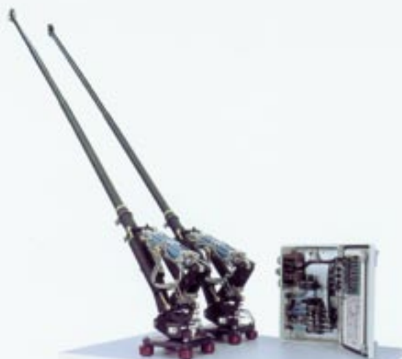
Trolleybus-Stromabnehmer mit Steuergerät Trolley per filobus con apparecchio di comando
